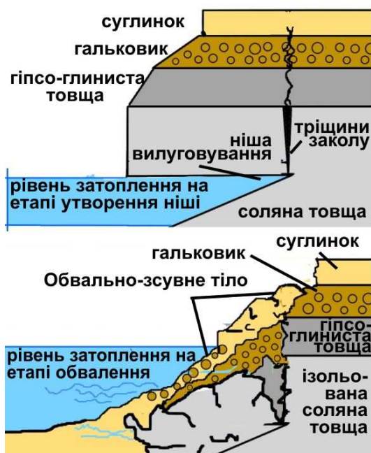
Рис.3. Деформації бортів кар'єру на етапах утворення ніші та обвальне-зсувних явищ.
