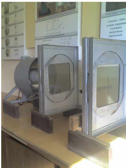
1 – короб з матовим склом і лампами; 2 – поляризатор; 3 – модель; 4 – аналізатор; 5 – екран
