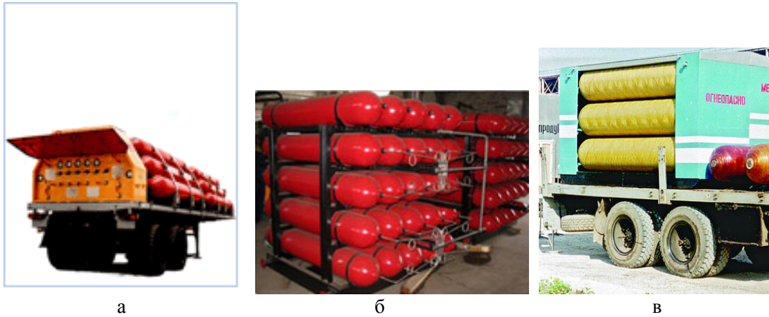
а – пересувна метанова заправка; б – балони для АГНКС; в - метановоз Рисунок 2 – Обладнання для пересувних АГНКС
