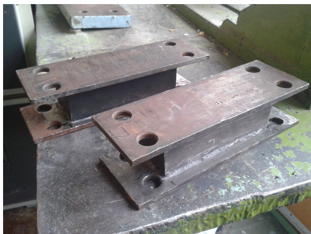
а – конструктивні особливості; б – загальний вигляд Рисунок 8 – Гумометалеві блоки
