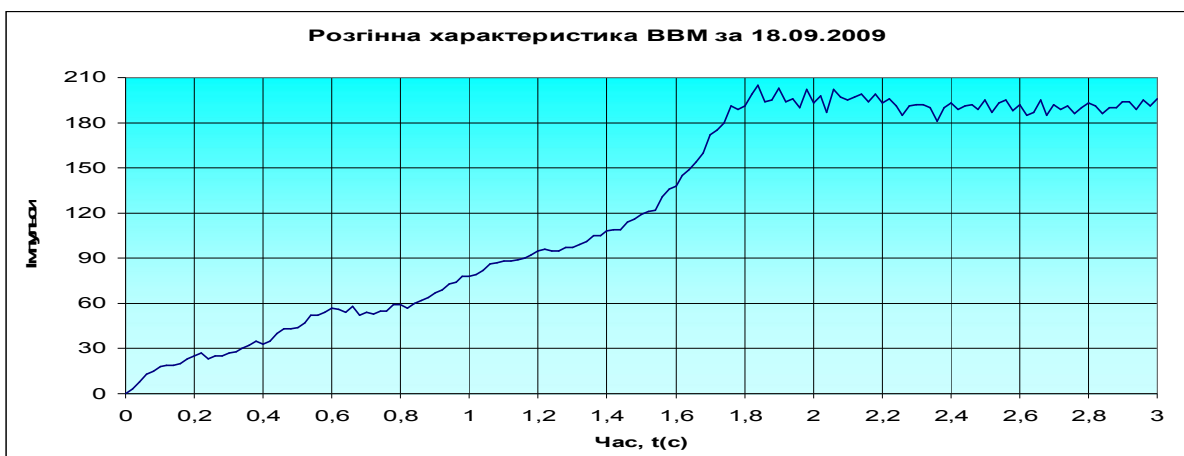
Рисунок 2 – Експериментальні розгінні характеристики млина
