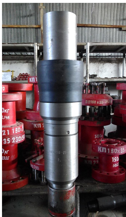
(а – конструктивне оформлення пакера; б – загальний вигляд пакера) 1 – корпус, 2 – упорний бурт корпуса, 3 – опорна втулка, 4 – манжета, 5, 6 – внутрішня та зовнішня робочі губи, 7 – заглиблення манжети; 8 – упор; 9 – регулююча гайка; 10 – перевідник; 11 – запобіжний радіальний отвір
