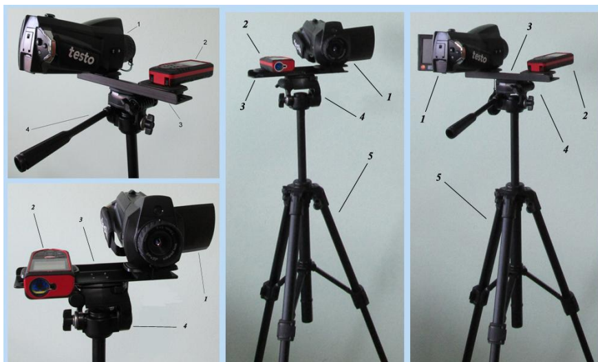
Рисунок 2 - Загальний вигляд апаратної частини комплексу тепловізійної дефектометрії
