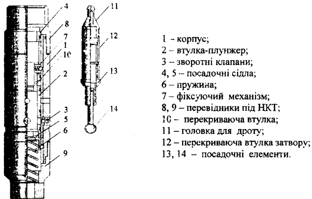
Рис. 8. Принципова схема пристрою для створення на пласт високих миттєвих депресій і репресій тиску УСМД-2(3)
