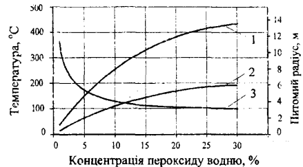
Рис. 13. Залежність температури розчину (1) і пласта (2) та питомого радіусу зони оброблення (3) від зміни концентрації \text{H}_2\text{O}_2 в реакції з \text{N}_2\text{H}_4 і з врахуванням продуктів реакції між \text{NaClO} і \text{NH}_3
