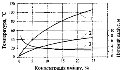
Рис. 12. Залежність температури розчину (1) і пласта (2) та питомого радіусу зони оброблення (3) від зміни концентрації \text{NH}_3 в його реакції з \text{NaClO}
