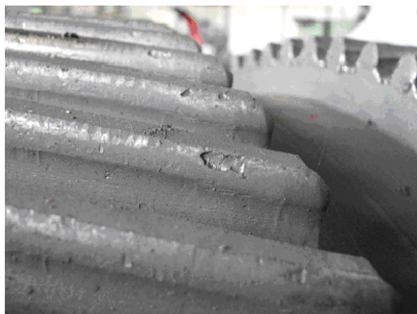
Рисунок 6 — Викришування поверхневого шару зубів
