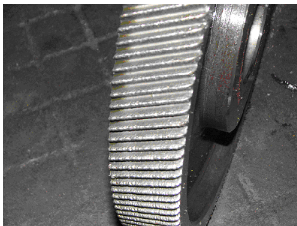
Рисунок 4 — Зубчате колесо проміжного вала редуктора Ц2НШ-750 після заїдання зубчатої передачі
