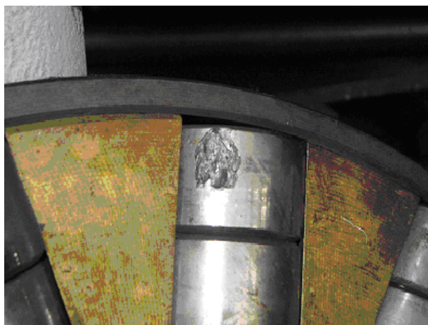
Рисунок 1 — Втомне викришування роликів підшипника
