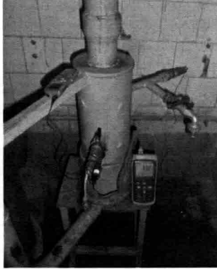
Рисунок 4 – Вимірювання процесу поширення температури та акустичних хвиль гідравлічного генератора імпульсно-хвильової дії
