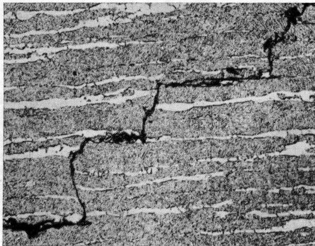
Рис. 116. Коррозионная трещина в стали 1X17H2, развившаяся после испытаний образца с искусственной усталостной трещиной в кипящем 0,5%-ном растворе NaCl.
