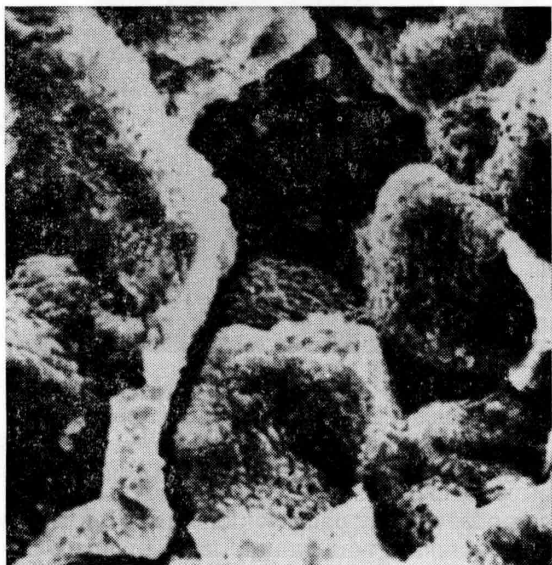
Рис. 85. Коррозионная трещина в стали 1X17H2 (закалка, отпуск 300°С), возникающая при испытании в высокотемпературной воде (350°С) ( \times 1000 ).
