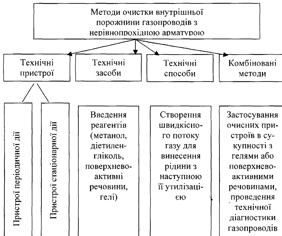
Рис.4.1 - Методи очистки газопроводів з нерівнопрохідною запірною арматурою
