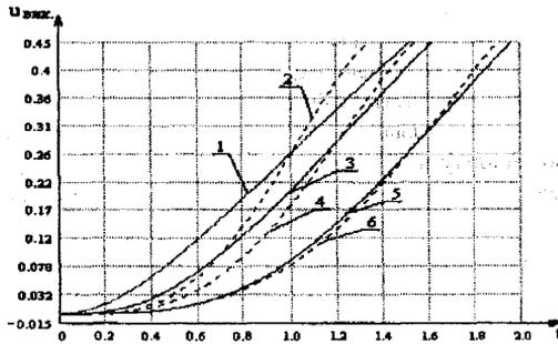
1 – 1-го порядку; 2 – оптимального в момент вимірювання  $\tau_{вим} = \tau_c$ ; 3 – 2-го порядку; 4 – оптимального в момент вимірювання  $\tau_{вим} = 1,2\tau_c$ ; 5 – 4-го порядку; 6 – оптимального в момент вимірювання  $\tau_{вим} = 1,7\tau_c$
