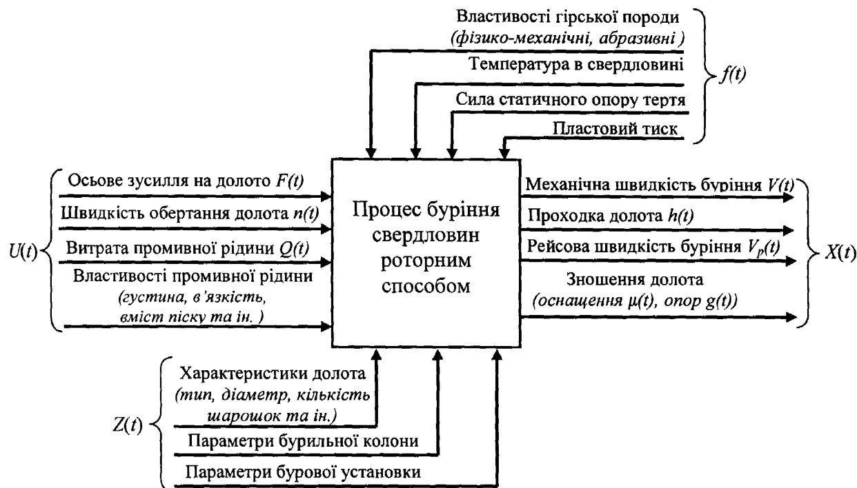
Рис.1.2. Структура моделі процесу буріння свердловин роторним способом
