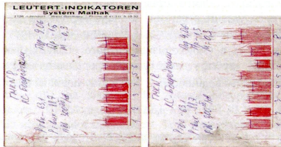
Рисунок 2 – Індикаторні діаграми силових циліндрів ГМК МК-8
