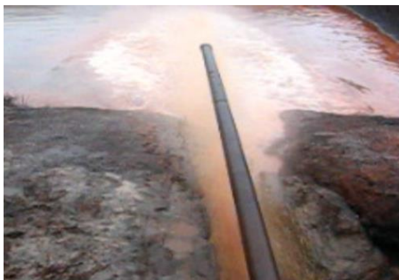
Рисунок 7.14 – Викид піни із свердловини в амбар та ліквідація піни для повторного використання рідини
