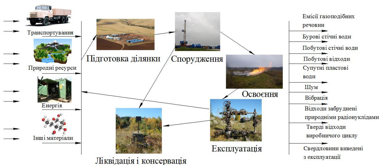
Рисунок 3.17 – Вхідні та вихідні потоки в системі «Нафтогазова свердловина»
