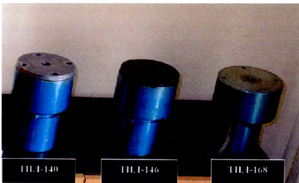
Рисунок 1.10 – Загальний вигляд торцевих печаток-уловлювачів
