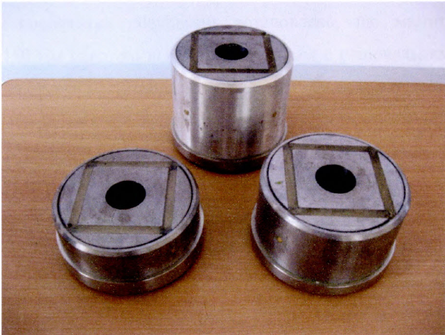
Рисунок 4.14 – Магнітні системи пристрою ПМЛ-195
