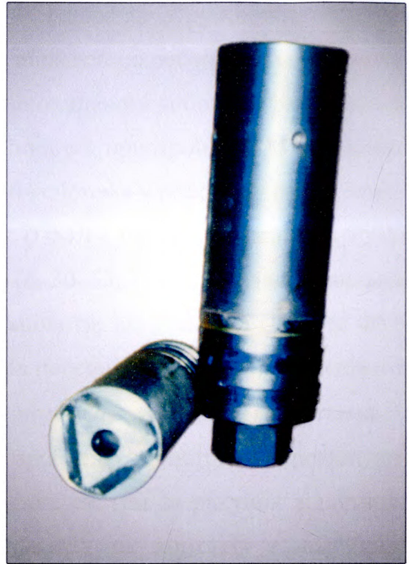
Рисунок 5.9 – Магнітні системи пристроїв ФУМ-112 та ФУМ-136
